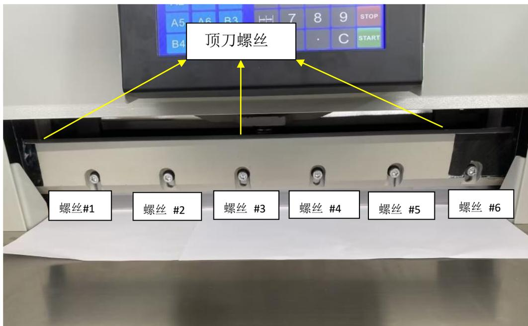
11.1 逆時針旋轉深度調整螺絲兩圈到 0 位同時進入設置按照第 8.7 章節把切刀深度設置為 0。
